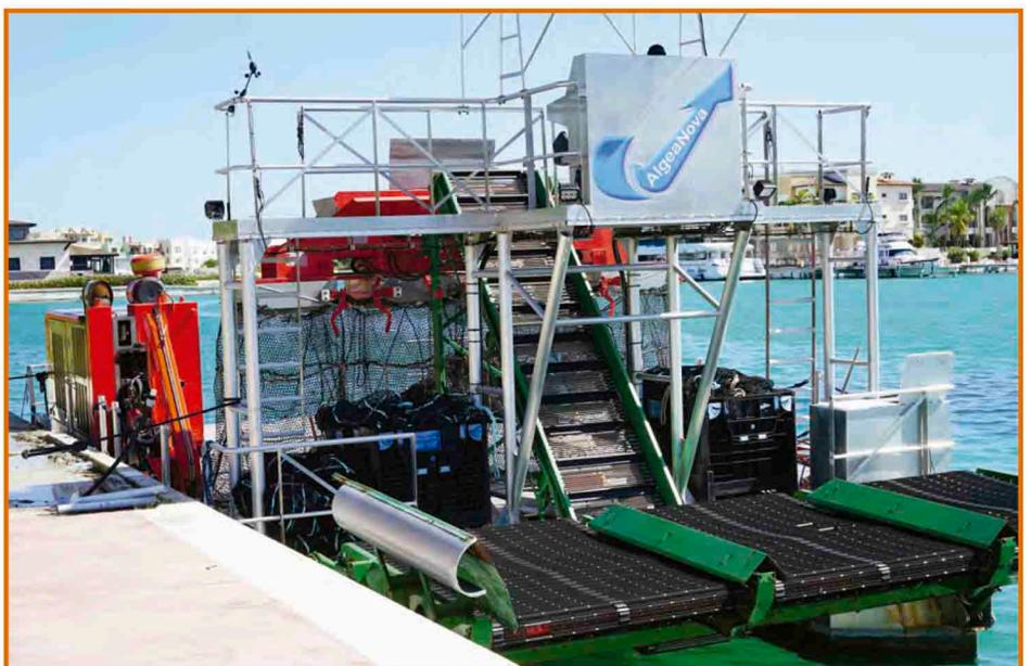
*La barcaza no es totalmente nueva, es Tecnología Apropiaada, toma varios elementos de otras maquinarias y los acopla a un uso local. Es un equipo Metalmecánico, específicamente un catamarán con un sistema de recolección de algas.*
